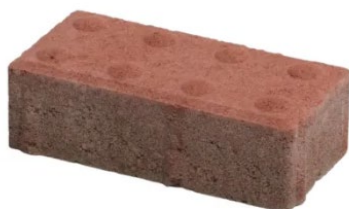
BEST KLASIKO, modulární skladební rozměr 100 x 200 mm, tl. 80 mm, zkosená hrana (fazeta), barva červená, reliéfní povrch pro nevidomé a slabozraké
